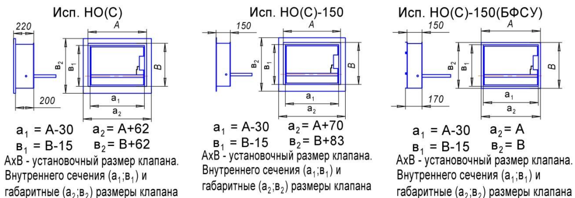
Рис.1. Установочные, габаритные и размеры внутреннего сечения клапана.
